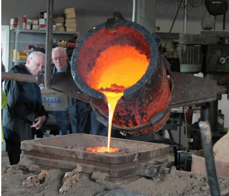
Die Glockenform wird mit flüssiger Bronze gefüllt.
